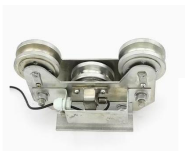
SLIKA 13 - MERAČ RELATIVNOG PRODUŽENJA GLAVNOG ČELIČNOG UŽETA [18]
