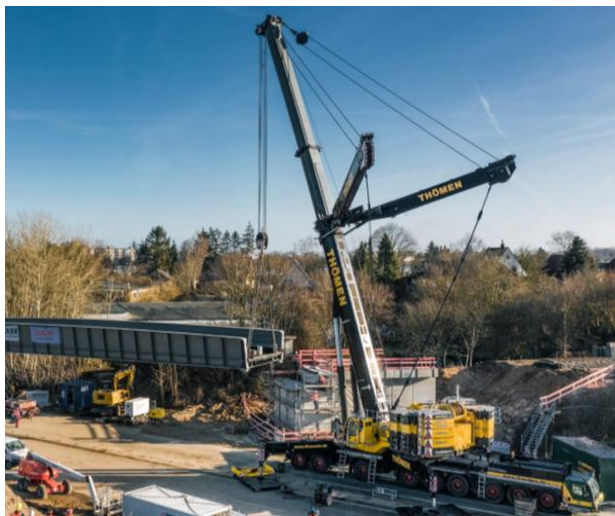
SLIKA 11 – AUTODIZALICA Liebherr LG1550 THÖMEN (u radu od 1992. god. sa više od 20.000 rad. čas.) [4]
