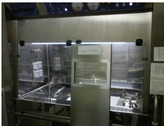
SLIKA 1 - a) Radiohemijska laminarna komora, standardna nuklearna medicina, UKCS - b) Automatski separator-injektor za pozitronske emitere (PET), UKCS Oba sistema u značajnoj meri, uz ostale mere zaštite, smanjuju izlaganje izloženih radnika.
