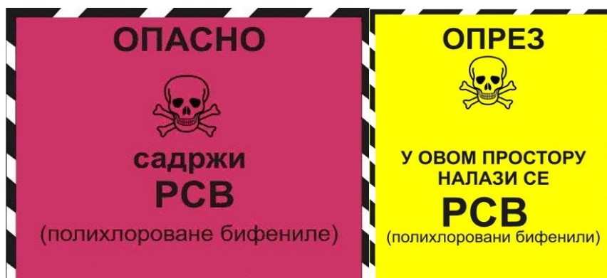
SLIKA BR. 1. I 2.. OZNAKA UREĐAJA KOJI SADRŽI PCB I OZNAKA PROSTORIJE U KOJOJ NALAZI PCB
