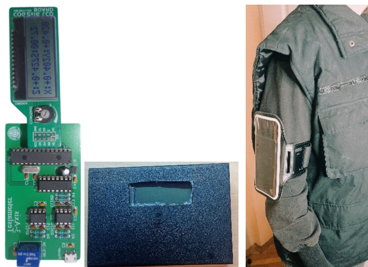
Slika 3 – Lični dozimetar magnetnog polja, struktura, izgled i način korišćenja (10)
