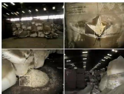
Slika 5 – Način skladištenja amonijum nitrata u hangaru 12 u luci u Bejrutu [9]
